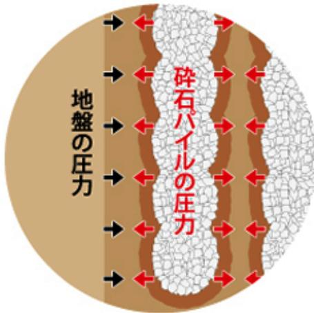
地盤→と←砕石パイルが互の圧力により 複合的に強い地盤になる
